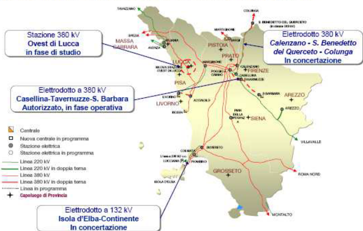
Fig. 22 - rete elettrica a 380 e 220 kV
